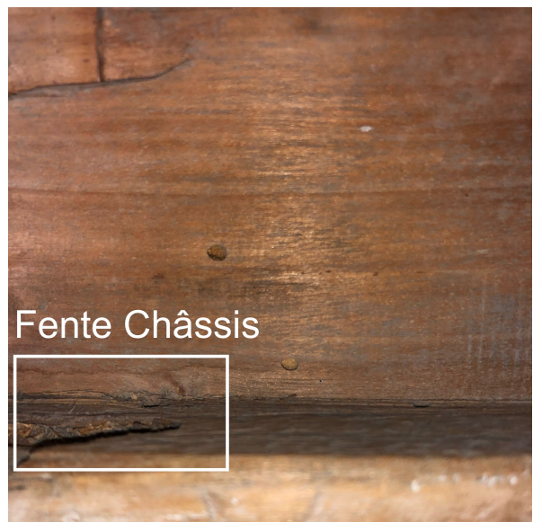
6. Traverse supérieure en partie dextre fendue
